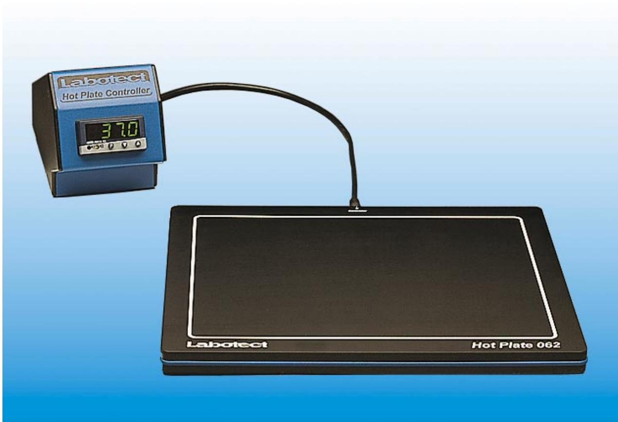
Die HP 062 besteht aus der Wärmeplatte und der Kontrolleinheit.
